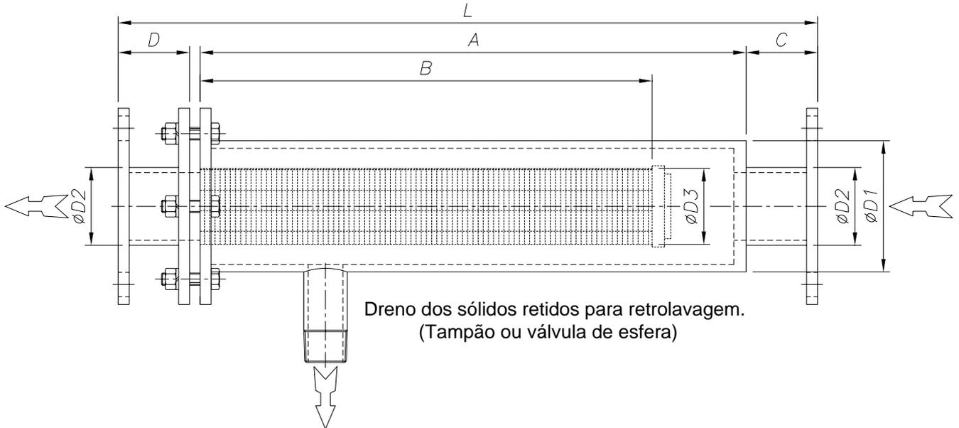
**NOTA:** As flanges serão fornecidas no padrão do tubo D2 com dimensional da norma ANSI B 16.5 Classe 150, faceamento liso, com exceção da espessura da flange que será definida pela Prominas.
